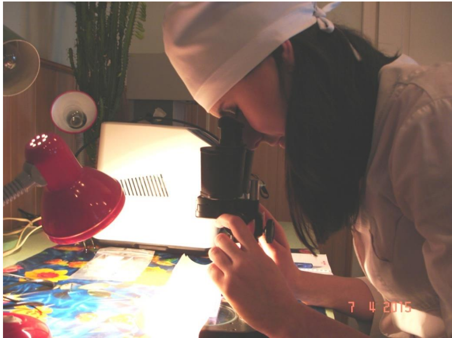
Рис 4. Вимірювання діаметру преципітату за допомогою міліметрового паперу і мікроскопу стереоскопічного БМ -51-2
