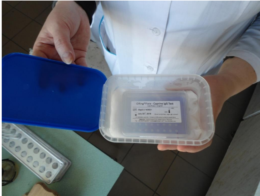
Рис 3. Внесення планшету з гелем у пластиковий контейнер (з вологим середовищем)
