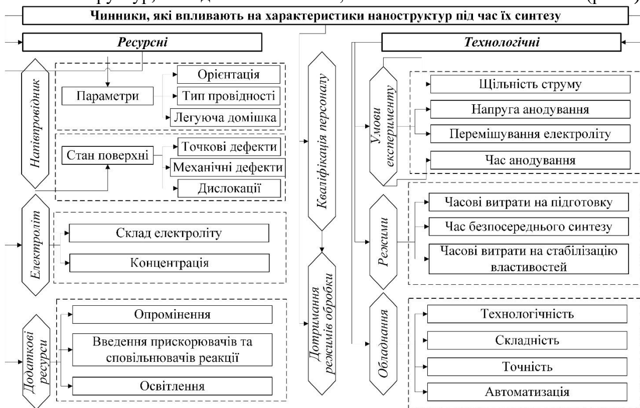
Рисунок 7 – Чинники для управління синтезом наноструктур із нормованими властивостями методом електрохімічного травлення
