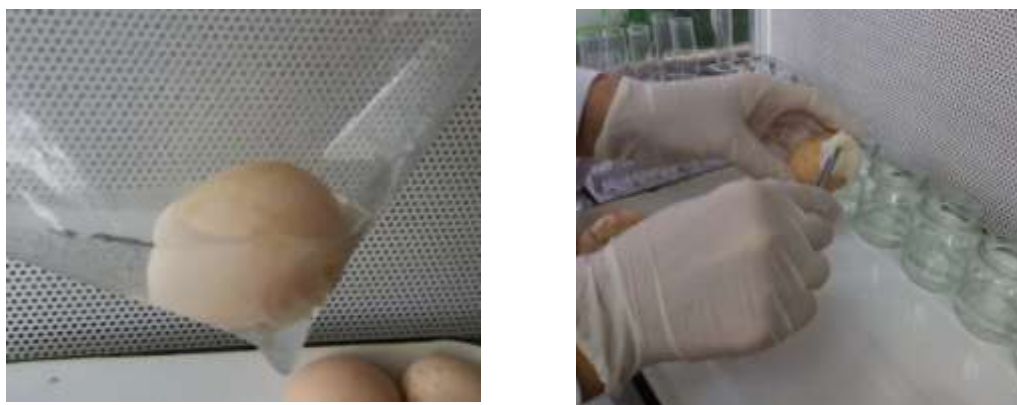
Рис. 2.2. Відбір змивів з поверхні шкаралупи інкубаційного яйця.
