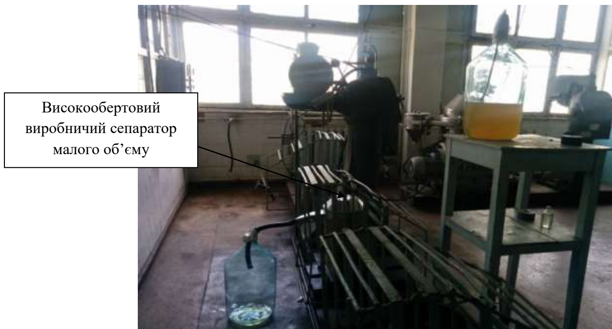
Рис. 3.5. Ультрацентрифугування осаду туберкулопротеїну за допомогою високообертового виробничого сепаратора малого об'єму. Фото авторів розробки.
